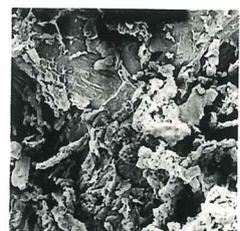
70% H<sub>2</sub>SO<sub>4</sub>、80℃、200hs耐蝕テスト顕微鏡写真
