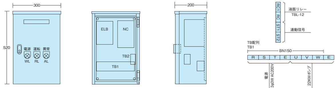
26KW起動盤（160kg）〈インバーター付〉
