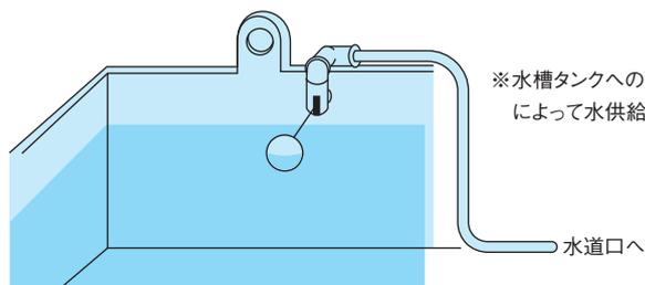
※水槽タンクへの水道ホースでの給水時、ボールの浮力によって水供給を停止し、オーバーフローを防止します。
