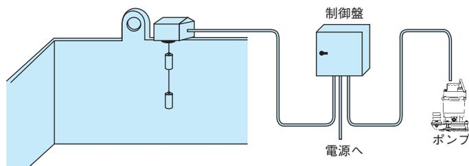
※水槽タンクへの水中ポンプでの給水時フロートの浮力・沈力によってポンプの電源を自動でON・OFFしてオーバーフローを防止し、かつ、自動で給水をスタートします。
